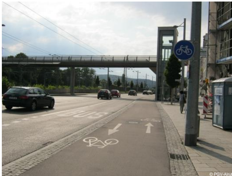
Abb. 6-4: Zweirichtungsweg (Beispiel Esslingen)
