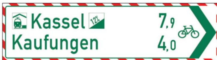
Abb. 7-5: Beispiel für einen Zielwegweiser mit farbiger Umrandung (entspricht „Umleitung“ gemäß Handbuch zur Radwegweisung“ in Hessen (2017) und dem Streckenpiktogramm „Steigung“
